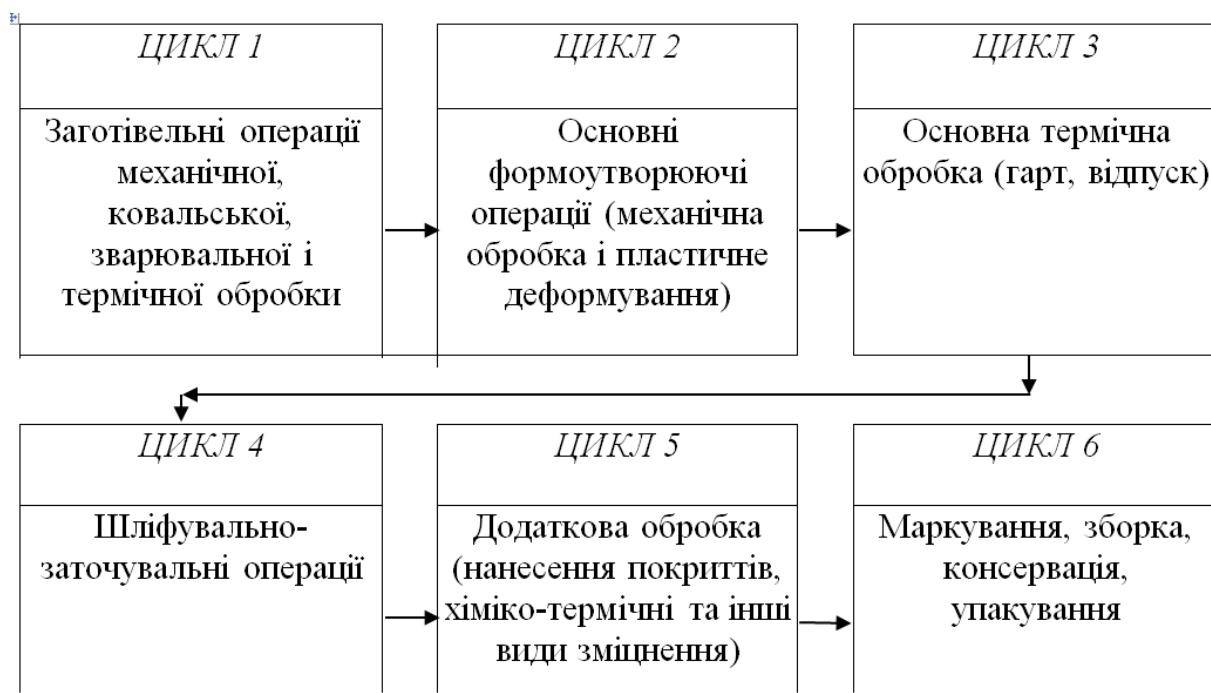
Рисунок 1 – Схема базового технологічного процесу
